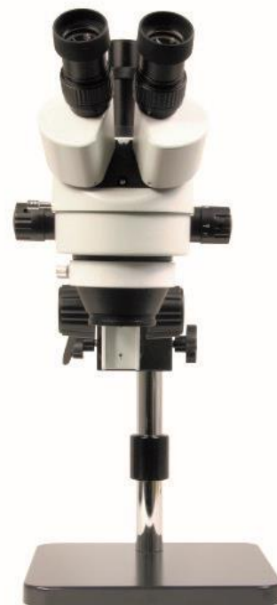
Mécanisme de zoom avec grossissement de 7 à 45 fois sans paliers
